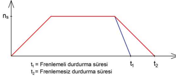
Görsel 3.1: Motorun frenlemeli ve frenlemesiz durma süreleri
