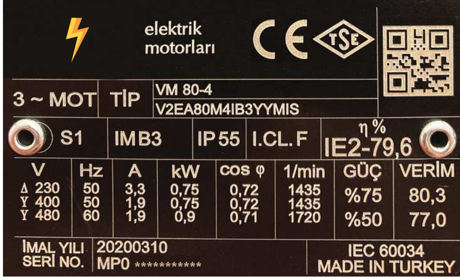
Görsel 1.3: Örnek bir asenkron motor etiketi
