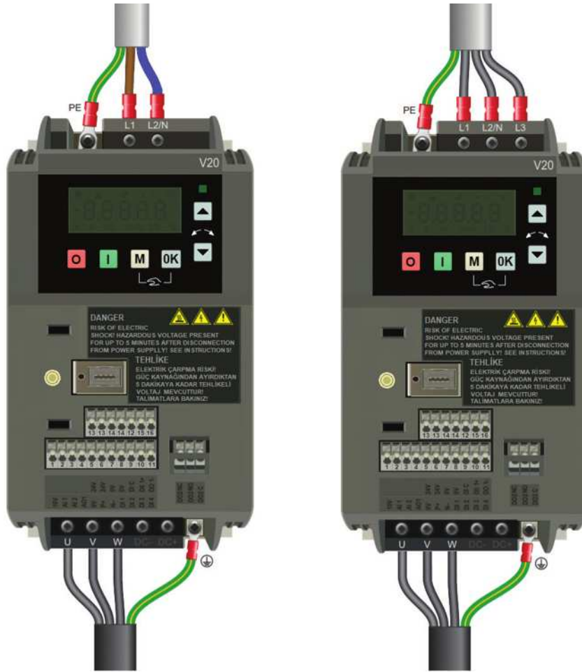
Görsel 2.9: Bir ve üç fazlı AC motor sürücü girişi ve motor bağlantısı
